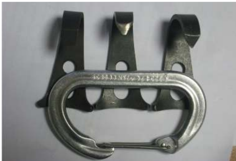
Cliffhanger: обычный, обрезанный и заточенный, заточенный в точку
